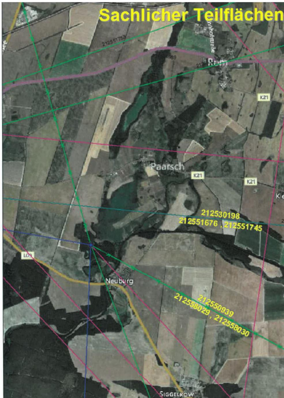
Die farbigen Linien verstehen sich als Punkt-zu-Punkt-Richtfunkverbindungen der E-Plus Service GmbH. Das Plangebiet ist im Bild mit einer dicken roten Linie eingezeichnet.
